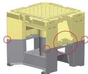
2 開き止めとステップキューブの連結部を確実に固定する
