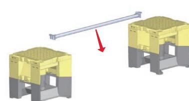
3 4カ所の連結台端部ピンとステップキューブ連結穴を確実に固定する
